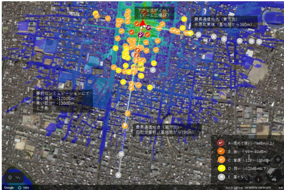
（写真 5）実験結果（電波強度測定結果とシミュレーションとの比較）
